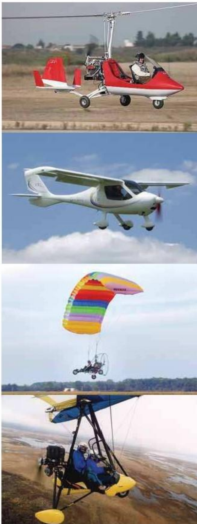
Figura 1-12. Ejemplos de LSA. De arriba hacia abajo: autootiro, aeroplano, paramotor, y pendular ó trike (WSC).
