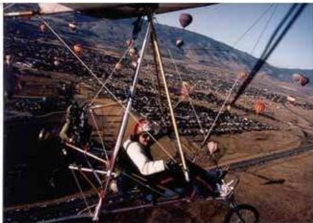
Figura 1-11. Ultraligero tipo Trike: Un ala tipo Rogallo sobre un carro motorizado.
