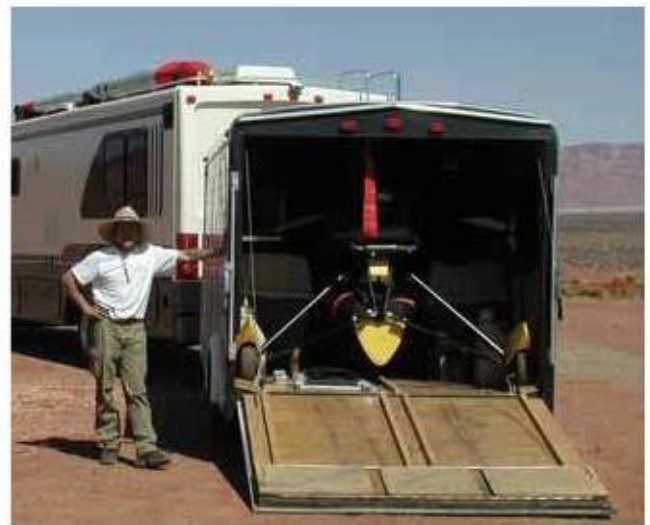
Figura 1-14. Ala plegada para transporte sobre un vehículo con el carro sobre un remolque
