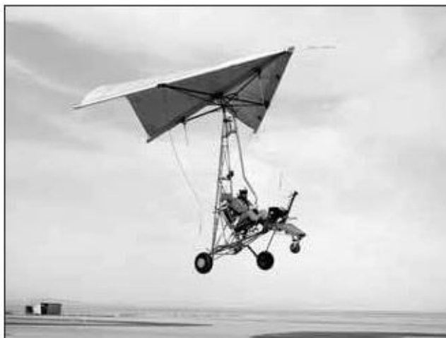
Figura 1-4. NASA probando el ala de Rogallo, la cual dió origen a las modernas Alas-delta y Aeronaves de tipo Pendular
