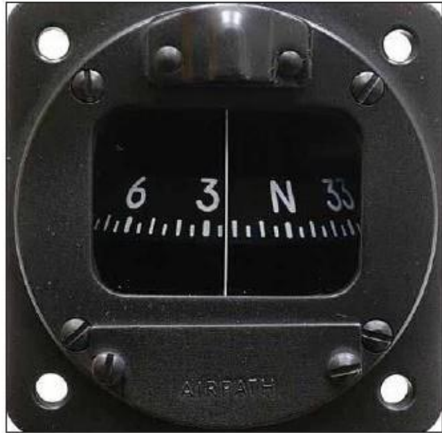
Figura 13-11. Brújula magnética analógica.
