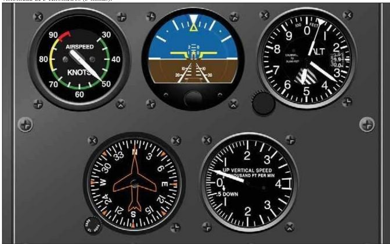
Figura 13-9. Indicadores de actitud para vuelo por instrumentos: indicador de actitud (arriba en el medio) e indicador de dirección (abajo izquierda) normalmente no instalados en un trike.
