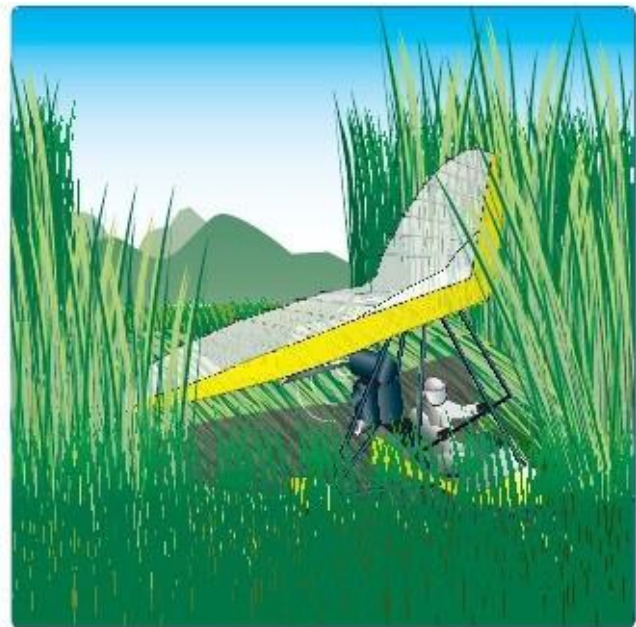
Figura 13-2. Usando vegetación para absorber energía.
