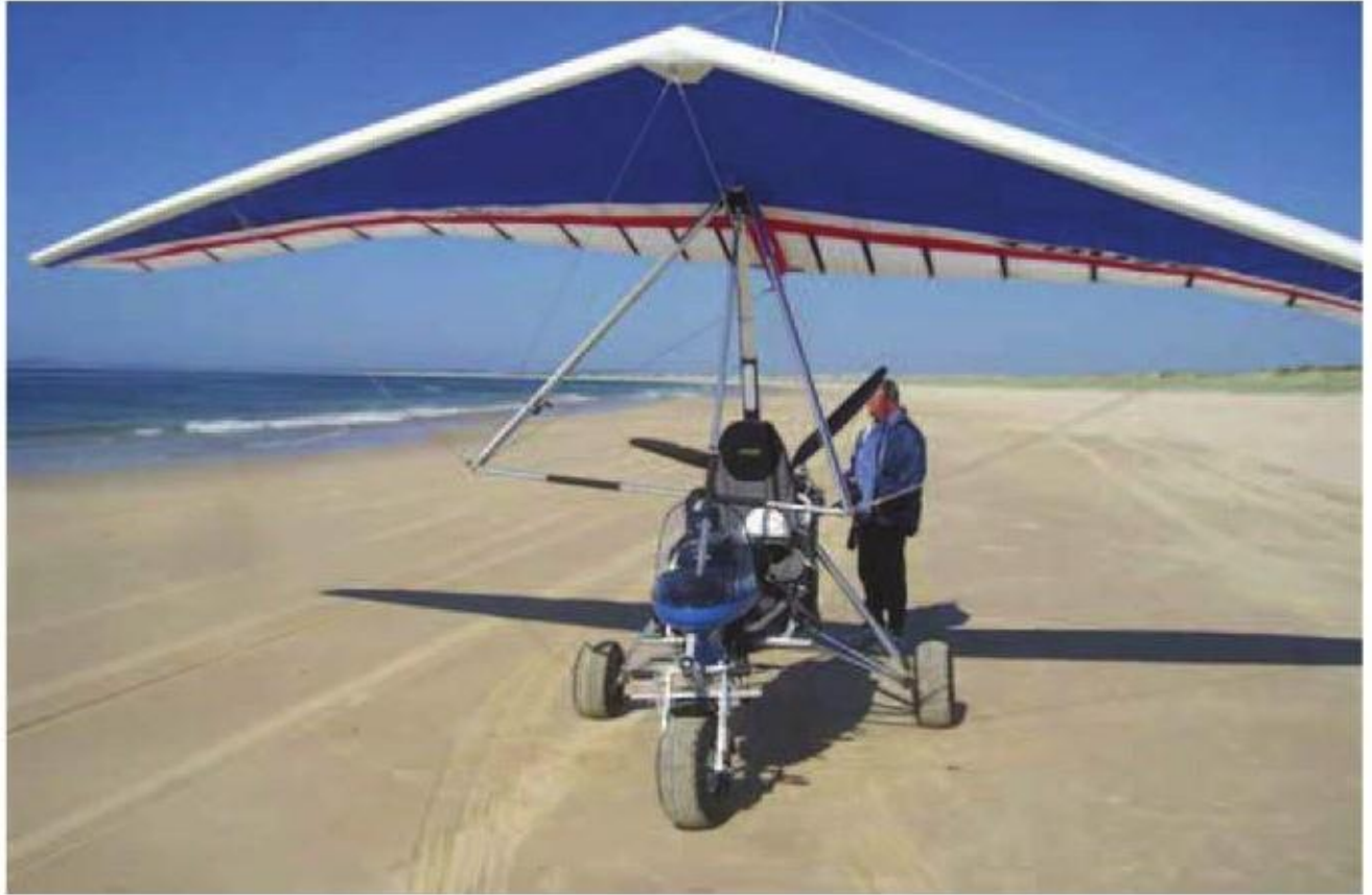
Figura 7-12. Ejemplo de trike diseñado con anchas ruedas de baja presión para poder operar en terrenos blandos.
