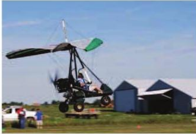
Figura 7-4. Momento después de levantarnos del suelo en un campo de hierba, con la barra de control levemente picada para un mayor velocidad, en caso de parada de motor.
