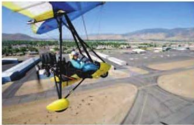
Figura 7-5. Posición de barra de control para la velocidad de mejor tasa de ascenso ( V_y ). En el caso mostrado, después del ascenso inicial tenemos ya suficiente altura de seguridad para una recuperación en caso de fallo de motor.
