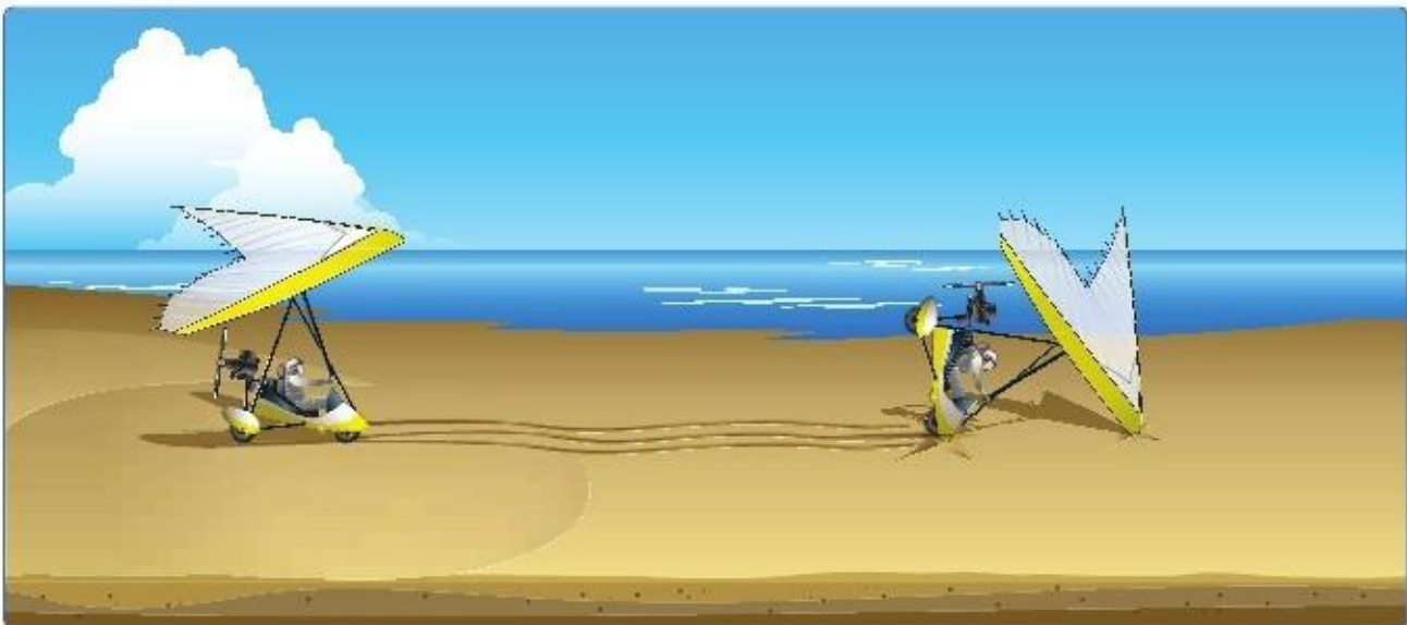
Figura 7-11. Limitaciones de un trike en despegue sobre terrenos blandos: La rueda delantera se clava y el trike capota.
