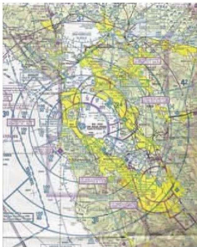
Figura 8-10. Espacio aéreo Clase B como se muestra en una carta de navegación seccional.
