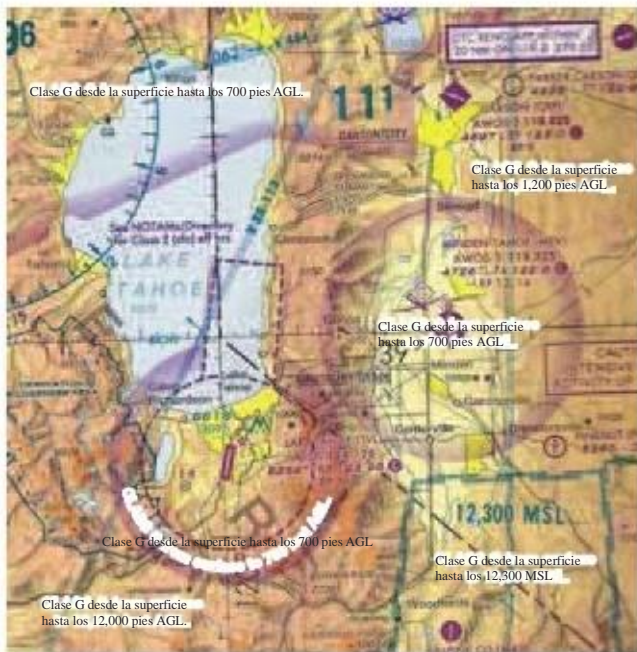
Figura 8-4. Espacio aéreo Clase G como se muestra en una carta de navegación seccional.
