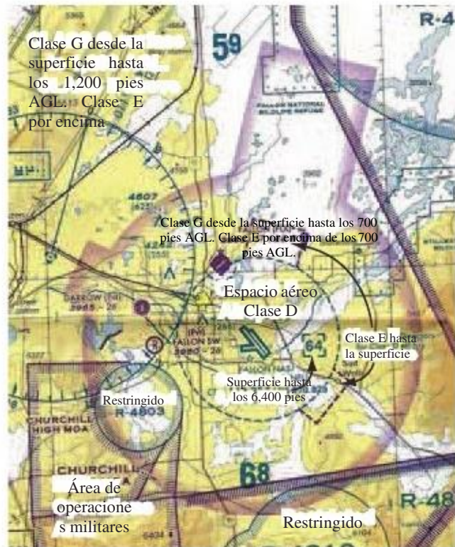
Figura 8-8. Espacio aéreo Clase D como se muestra en una carta de navegación seccional.
