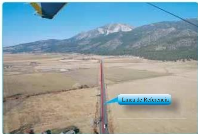
Figura 9-7. Punto de vista del piloto al cruzar la línea de referencia (carretera) a 90^\circ , manteniendo los planos nivelados al comenzar la maniobra.
